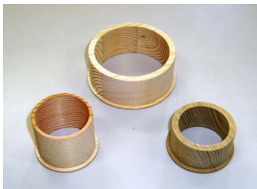
写真 1 同一プログラムによる複数形状の加工
