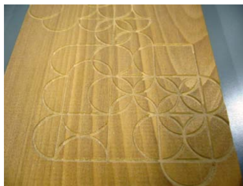
写真 3 乱数を用いた不規則模様の加工
