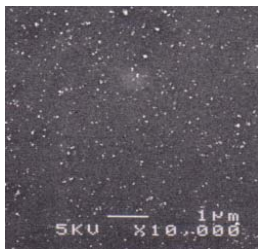
写真1 酸化チタン粒子分散シリカ薄膜のSEM像
